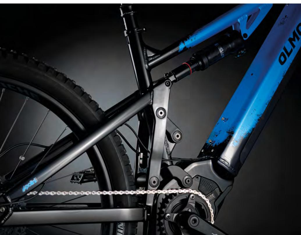
**FR.** Le système de suspension posséde un pivot principal intégré de la bielle inférieure. Il utilise un concept innovant pour une meilleure intégration avec l'unité de transmission.
